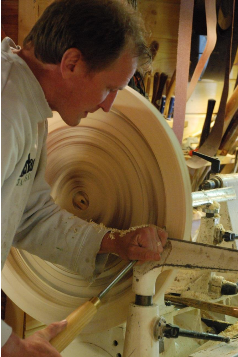
Bjørn-Gunnar Eliassen dreier felg til rokkehjulet.
