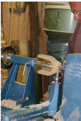
Tredreier Bleken dreier vingen utvendig.
