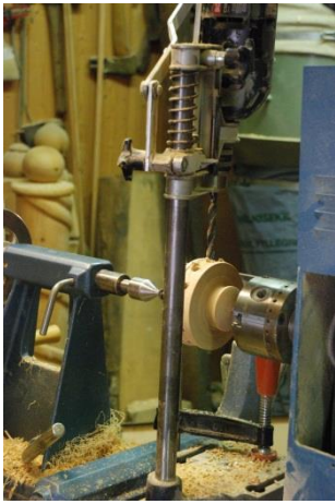
Det bores hull i navet til spiler.
