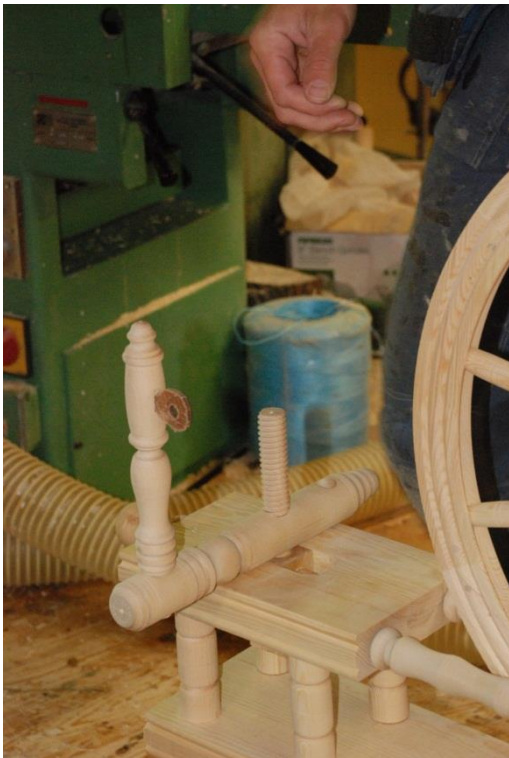
En stiv lærbit med hull til tein festes til jomfru (og dronning) for å holde vingen med trinse og snelle.
